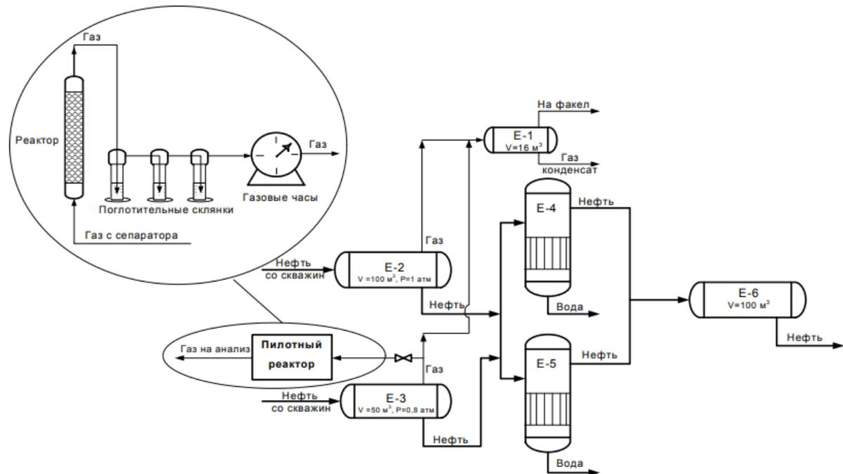
Принципиальная технологическая схема подготовки нефти на ГЗНУ-560 «Троицкнефть»
