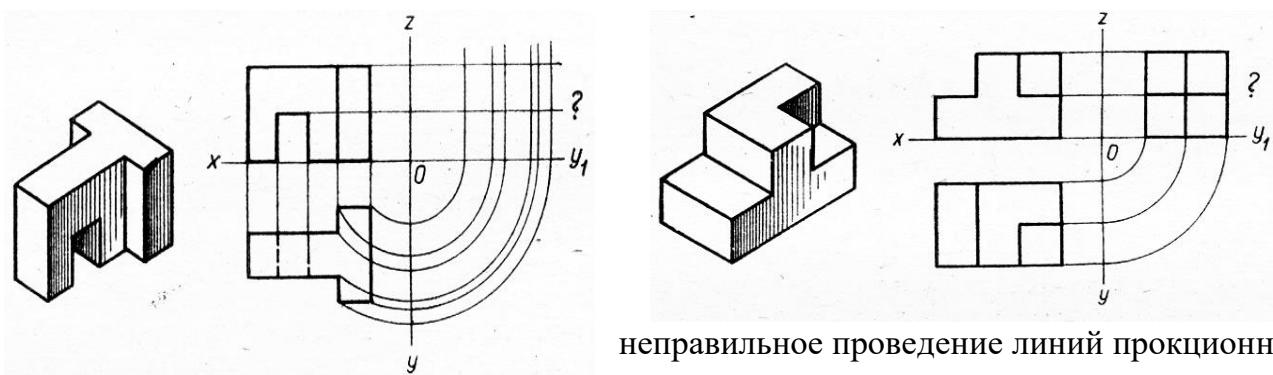
неправильное проведение линий проекционной связи.
