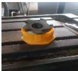
4-расм. Юқори тезликда торецли фрезалаш учун F730 маркали кесувчи асбоб
