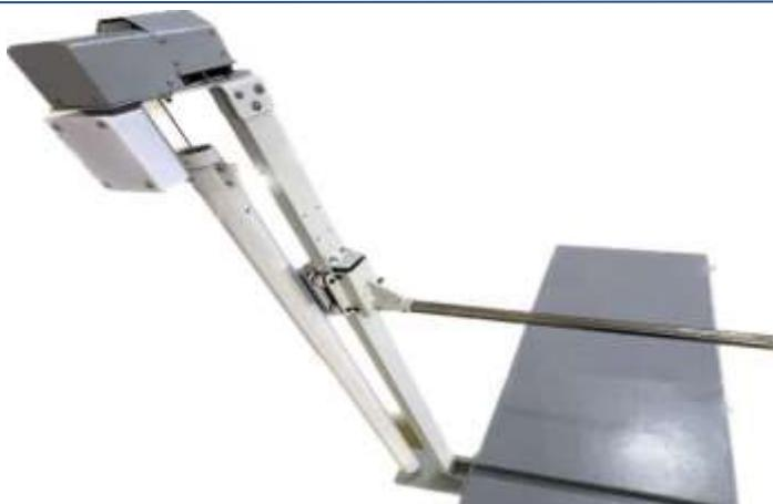
Устройство состоит из: платформы (1); стойки (2); каретки (3) с измерительной штангой (4); измерительный датчик (5); электронный блок (6); узел противовеса (7) – рис. 2.
